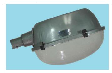
**Construção:** corpo refletor estampado em chapa de alumínio de alta pureza e anodizado brilhante; suporte com encaixe liso para tubo com Ø 25,4 m/m e; para a versão (PP) fechos e anel de segurança em aço inox; hermeticamente fechado através de junta de vedação; soquete cônico em porcelana com rosca E-27 ou E-40; fiação em cabo flexível de 1,5 m/m².
